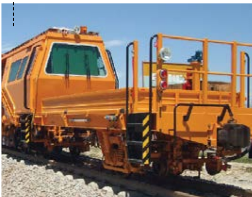
BATEADORA DE VÍA
